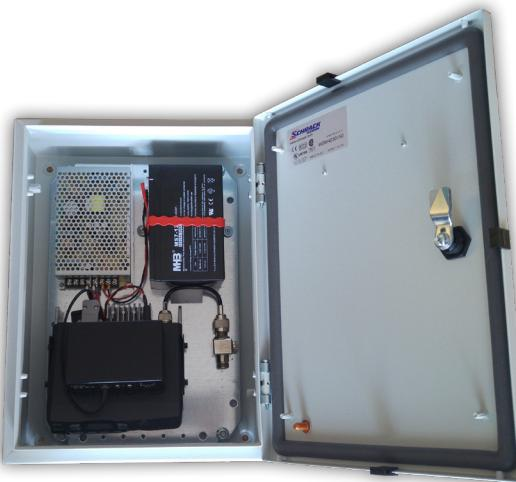
UHF/VHF РАДИОПРИЕМНИК НА ДО
